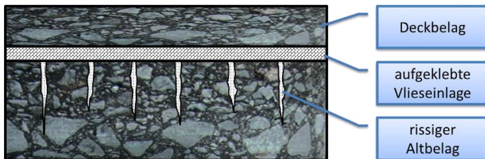
Derart aufgeklebte Spezialviese oder Gitter reduzieren das Übertragen von Belagsrissen auf den Deckbelag und verlängern dadurch die Lebensdauer der bituminösen Deckbeläge und der Strassen im Allgemeinen.
